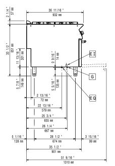
Electrical inlet (power) Equipotential screw EQ Gas connection
